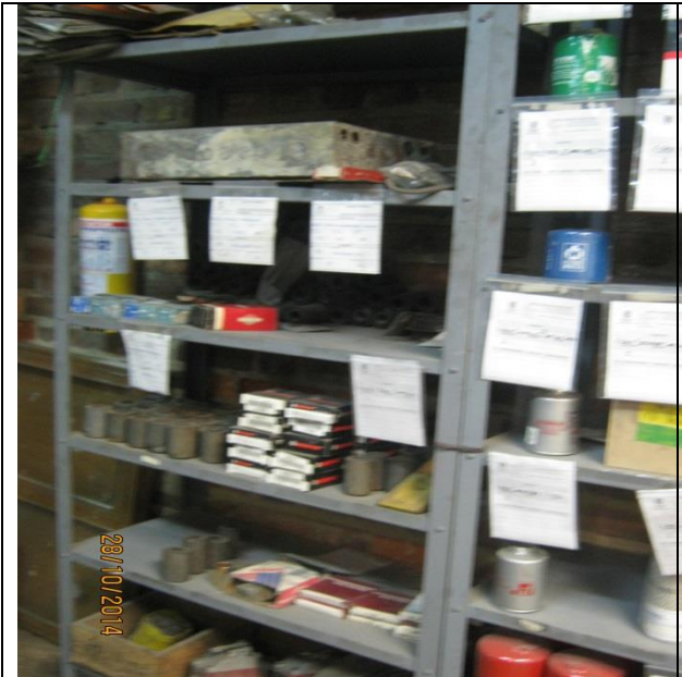
Foto 5. Panorámica de la bodega de repuestos para automotores de la UAERMV. En este sitio se almacena, filtros de aceite, filtros de aire, empaquetaduras, bujes para muelles.
